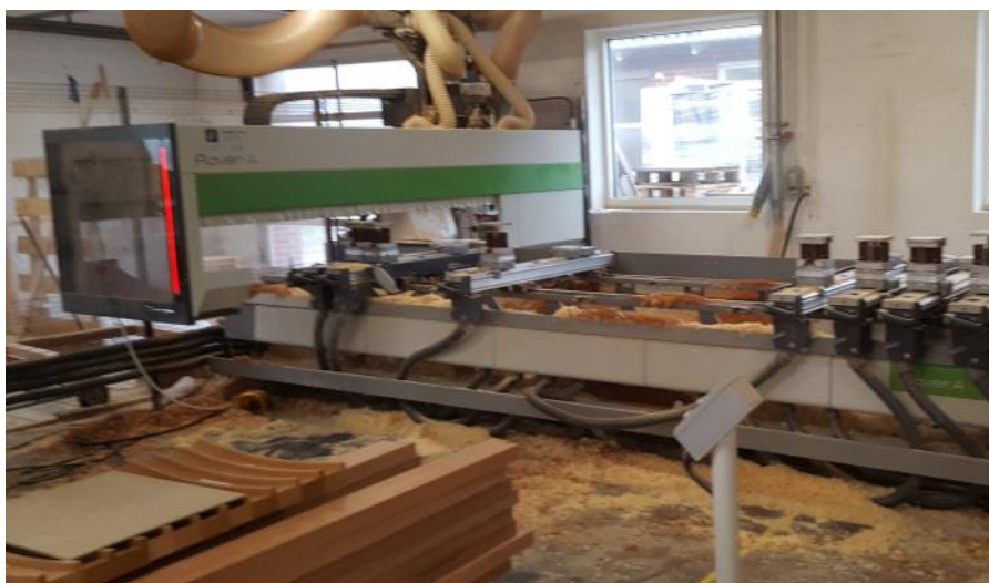
Tegninger med mål sendes fra administrationens tegneprogrammer via lokalnet til cnc-maskiner. Ordrene kører i serier og emnerne er mærket hele vejen igennem processen, så der er styr på det. De computerstyrede maskiner udfører flere arbejdsgange i ét hug.
