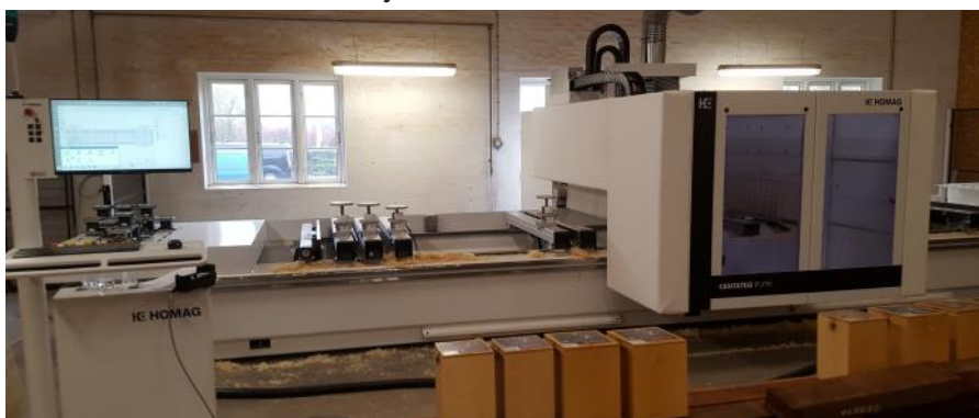
Tegninger med mål sendes fra administrationens tegneprogrammer via lokalnet til cnc-maskiner. Ordrene kører i serier og emnerne er mærket hele vejen igennem processen, så der er styr på det. De computerstyrede maskiner udfører flere arbejdsgange i ét hug.
